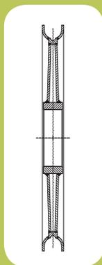
В блоках данного типа **ручей** служит не только для прохождения подъемного каната, но и как соединительный элемент. Особенность конструкции состоит в том, что две боковины приварены к центральному обработанному кольцу для прохождения каната. В остальном эти блоки не отличаются от обычных и могут изготавливаться со спицами, как в исполнении В или с двумя выпуклыми фланцами, как в исполнении С.
